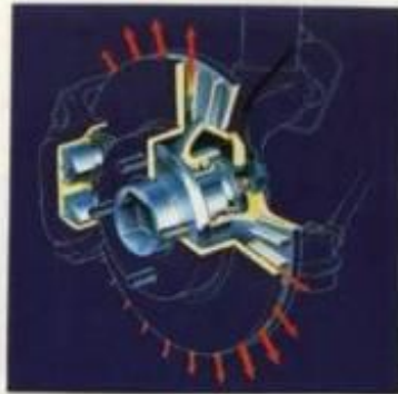
Abbildung rechts: Innenbelüftete Scheiben- bremse mit ABS-Sensor.
